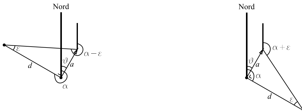
Figure 16: Calcul de la zone de confiance transversale pour un point situé sur la gauche ou sur la droite.
